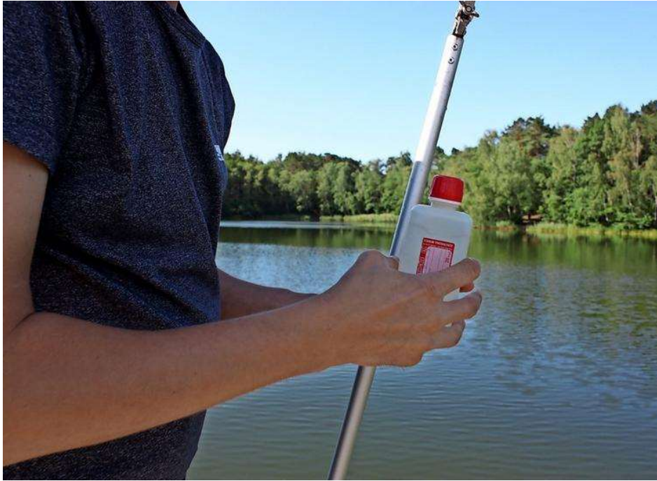
Ein Viertel Liter genügt, um im Labor alle notwendigen Tests durchzuführen. Quelle: Victoria Barnack
